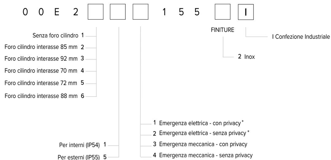
\* SOLO compatibili con configurazione senza foro cilindro (codice 1 in quinta posizione)
