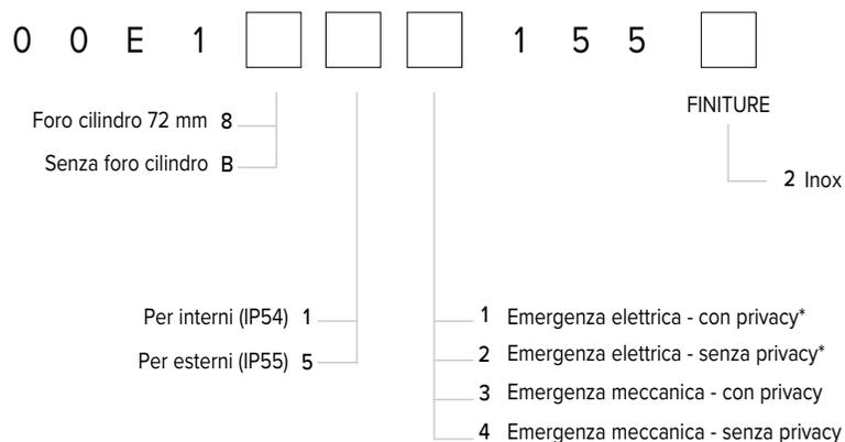
\* SOLO compatibili con configurazione senza foro cilindro (codice B in quinta posizione)
